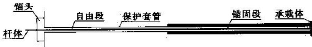
图 1.2.4 压力型预应力锚杆示意图
