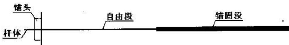
图 1.2.1 锚杆结构示意图
