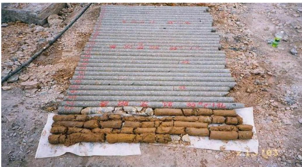
图 11-14 35 号桩孔 2 芯样照片
