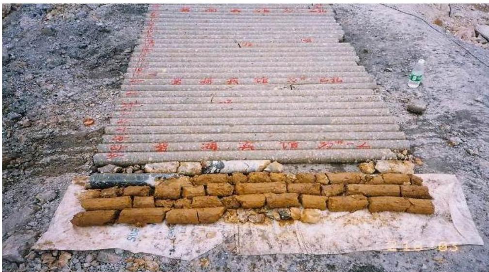
图 11-13 35 号桩孔 1 芯样照片
