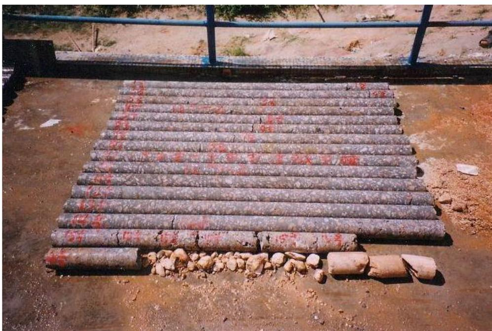
图 11-11 12 号桩孔 2 芯样照片
