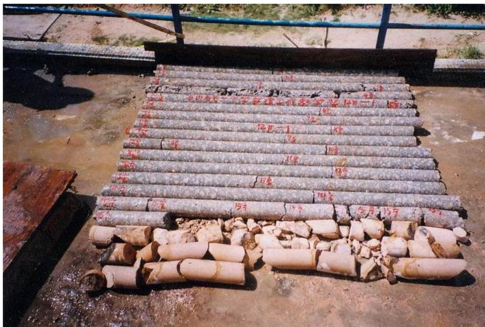
图 11-10 12 号桩孔 1 芯样照片
