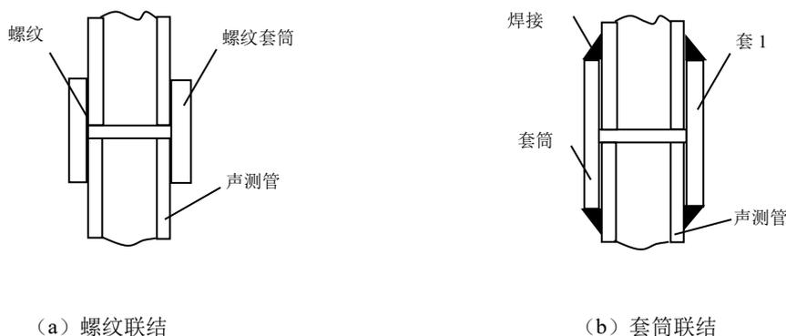
图 33 声测管的联结
