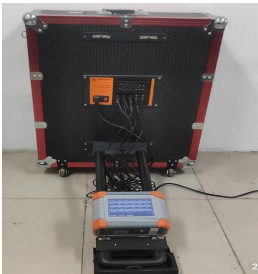
图2 建筑热工温度与热流自动测试系统
